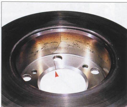
Rys. 4.5. Rozległe pęknięcia tarcz hamulowych
