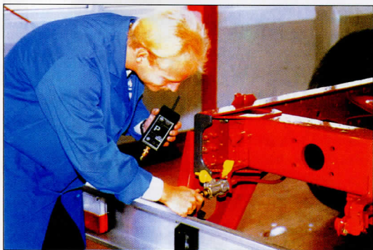
Rys. 6.7. Czujniki ciśnienia bezprzewodowe - radiowe w instalacji pneumatycznego uruchamiania w samochodzie do pomiaru sił hamowania
