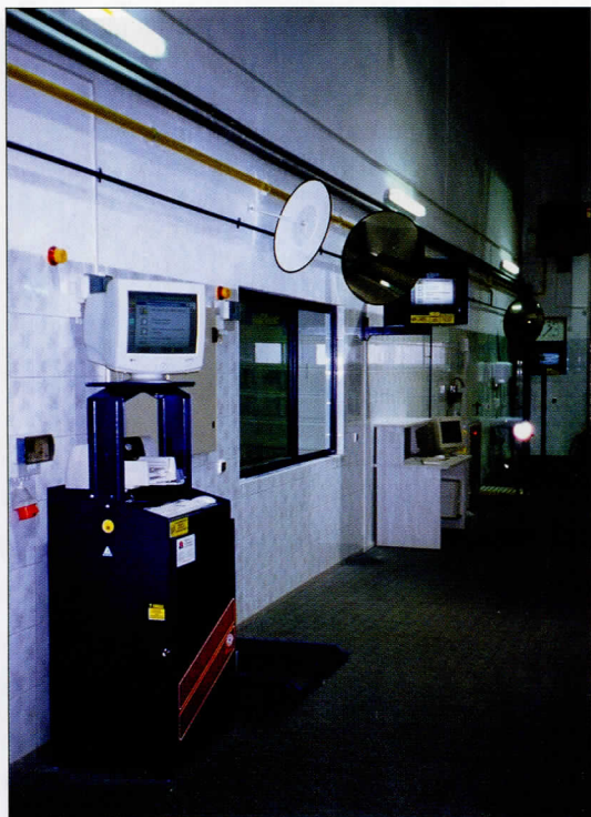
Rys. 6.9. Monitor i szafa sterująca, monitor z niezależnym komputerem i wskaźniki zegarowe tradycyjne - analogowe
