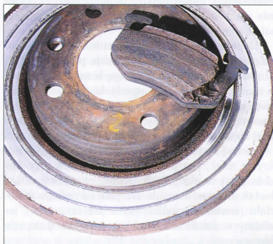
Rys. 4.3. Tarcza hamulcowa i okładzina wykazujące głębokie rysy powierzchni
