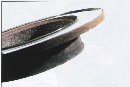
Rys. 4.8. Tarcza o zużyciu przekraczającym wartość dopuszczalną
