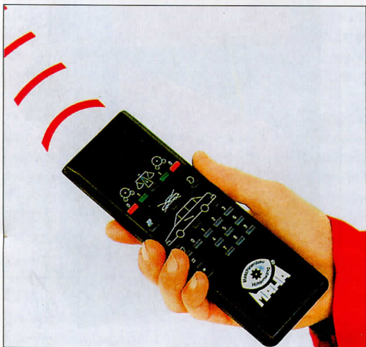
Rys. 6.8. Pilot - element wyposażenia stanowiska diagnostycznego
