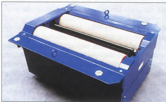
Rys. 2.2. Moduł rolek jako samodzielny zespół przed wmontowaniem w fundament stanowiska kontrolnego - widoczna „chropowatość” powłoki pokrywającej rolki
