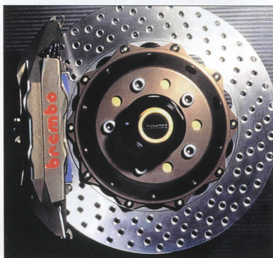
Rys. 1.20. Wygląd tarczy hamulcowej z wykonanymi otworami osiowymi, przeznaczonej dla samochodu wyczynowego
