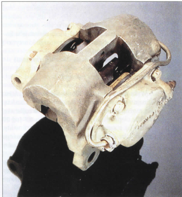
Rys. 1.9. Jedna z pierwszych konstrukcji zacisku hamulca tarczowego opracowana przez firmę Dunlop (1953 r.)
