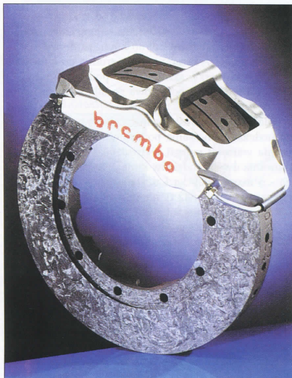
Rys. 1.6. Budowa nowoczesnego hamulca tarczowego wykorzystującego kompozyt węglowy do budowy tarczy
